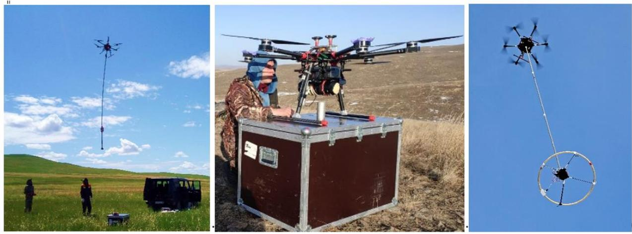
Некоторые БПЛА-геофизические технологии ИРН ИТУ и консорциума i.GeoDesign: а) система для комплексной магниторазведки и гамма-радиометрии, б) для гамма-спектрометрии, с) для электромагнитных зондирований
