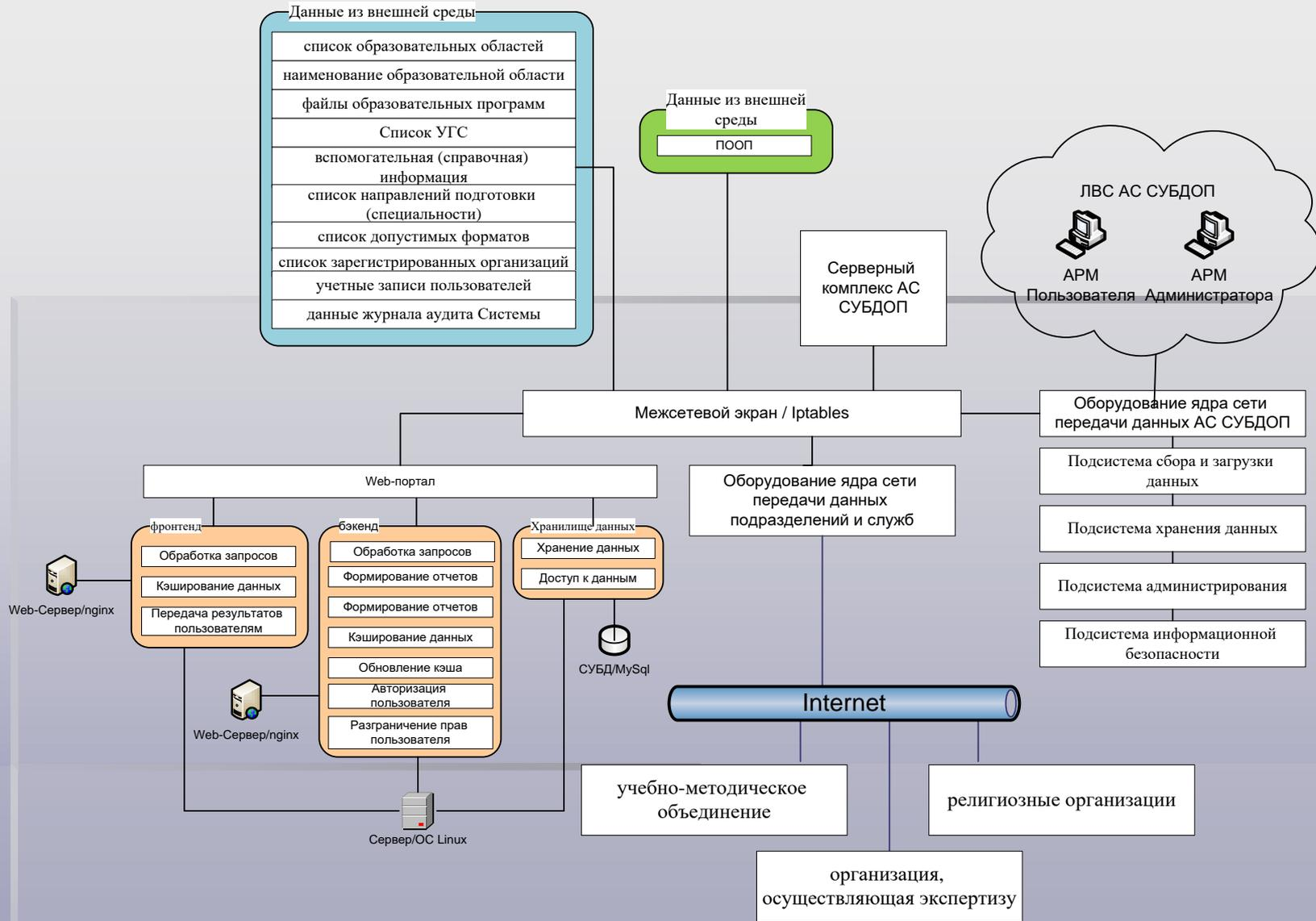
**Схема структурная комплекса технических средств**
