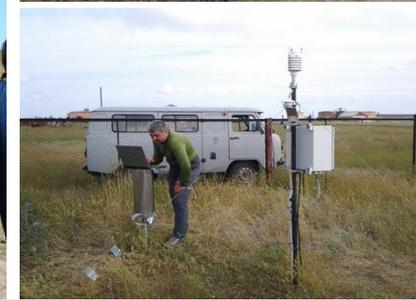
Лизиметрическая станция представляет собой уникальный комплекс приборов, предназначенный для изучения процессов переноса тепла, влаги и химических веществ в почве, в том числе количественного изучения процесса испарения
