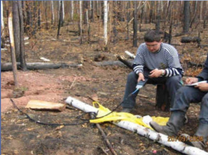
Термометрические наблюдения в скважинах
