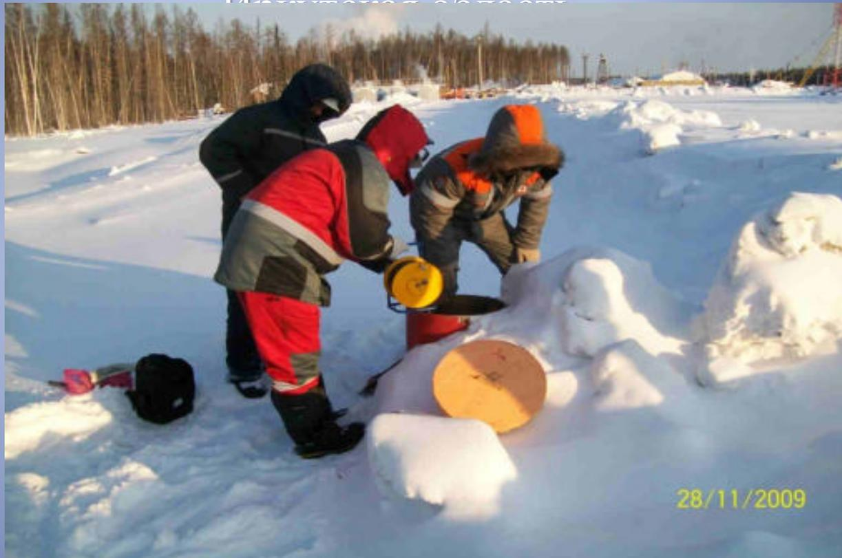
Термометрические наблюдения в скважинах
