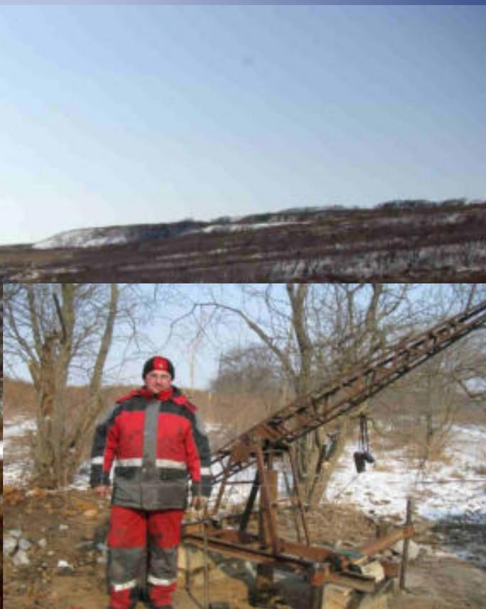
Штамповые испытания в скважинах
