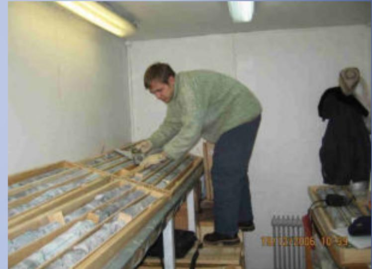
Геомеханическое описание керна горных пород и отбор монолитов для лабораторных исследований
