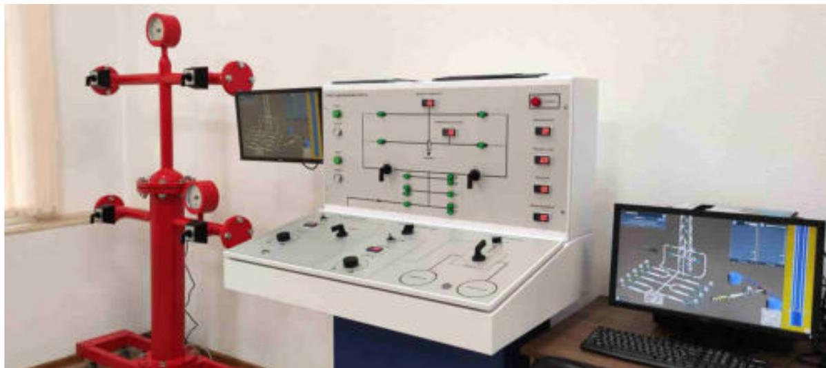
Полноразмерный пульт управления и блок устьевой арматуры обеспечивают возможность отработки моторики пользователя при выполнении виртуальных сценариев аналогично пультам реального оборудования.
