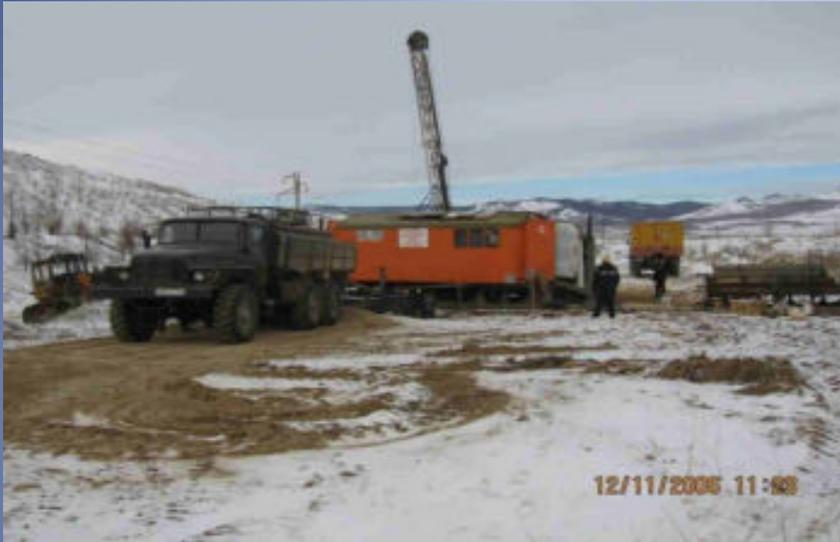
Бурение инженерно-геологических скважин с подъемом ориентированного керна
