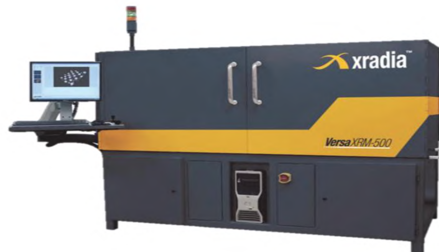
3D-рентгеновский микротомограф VersaXRM-500
