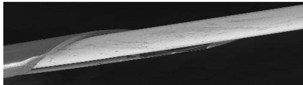
Аморфный микропровод с частично удаленной стеклянной оболочкой с d = 65 \text{ мкм}/D=85 .
